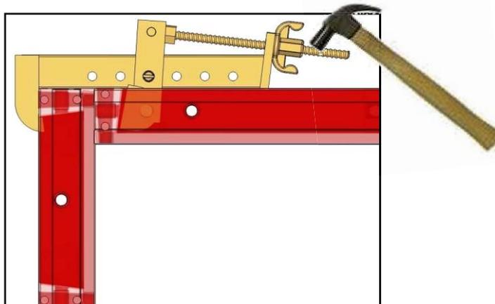
**УСТРОЙСТВО ПРИ ПОМОЩИ ЩИТА 500 MODULO S100 + УНИВЕРСАЛЬНОГО ЗАМКА + ПЛАСТИНЫ-УПОРА ТОРЦЕВОЙ ЧАСТИ СТЕНЫ 3000**
