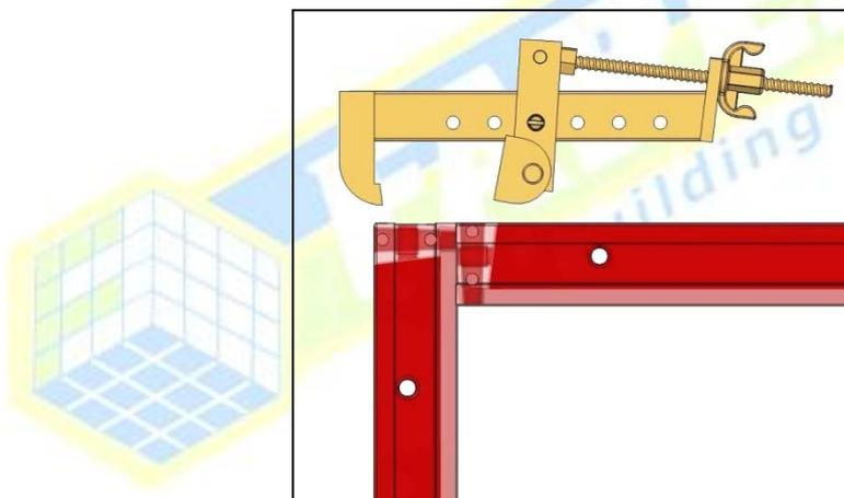
Закрепить универсальный замок, отрегулировав барашковую гайку
